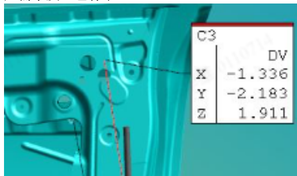
图(5) 隐藏式门把手安装板凸焊螺母尺寸数据显示图
