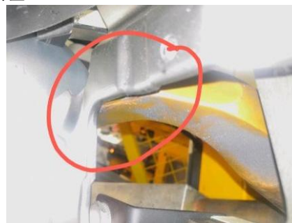
图(6) 制造过程焊接机器人与零部件干涉图
